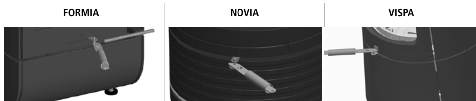
Obr. 3.12 Ke změně nastavení spalovacího vzduchu je třeba používat ovládací rukojeť
